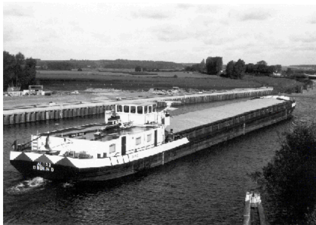
Bild 4: MS ALBA 2* - ein neues Schiff mit den "Berlin" - Abmessungen Länge = 80,00m / Breite = 9,00 m
