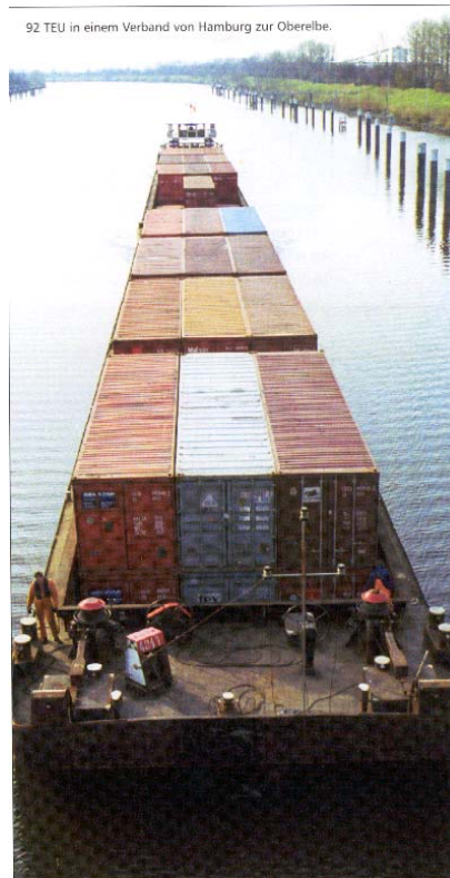
Bild 1: Schubverband der DBR auf der Elbe vor der Schleuse in Geesthacht (Beladen mit Standard-Container in zwei Lagen mit je drei Breiten, im Vorschiff des Schubleichters ist die Verbreiterung um 1,30 m auf die neue Schiffsbreite von 9,50 m erkennbar) ELK geeignet.
