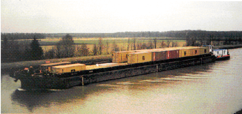
Bild 8: Container-Schubverband der DBR auf dem Elbe-Seitenkanal mit verbreitertem Schubleichter, beladen mit 3 Reihen nebeneinander und 2 Reihen übereinander Quelle: H.W. Dünner/ H. Chr. Knoll: "50 Jahre Deutsche Binnenreederei", Köhler 1999, S. 153
