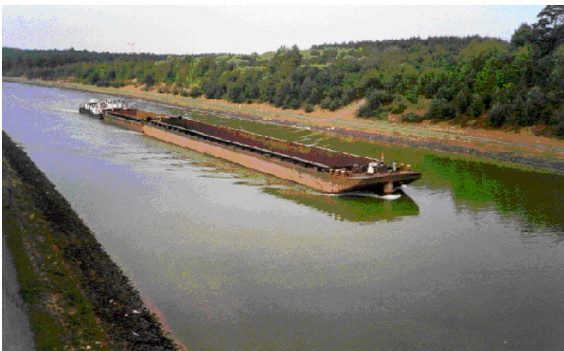
Bild 6: Standard-Schubleichter der DBR-Länge 32,50 m / Breite 8,20 m (Laderaum mit "Wallgängen")
