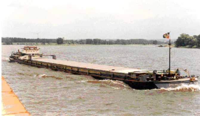
Bild 3: MS DREIKLANG - ein Schiff vom Typ "Gustav Koenigs" (verlängert auf L = 80,00 m, Querschnitt 8,20 m - Schiff)
