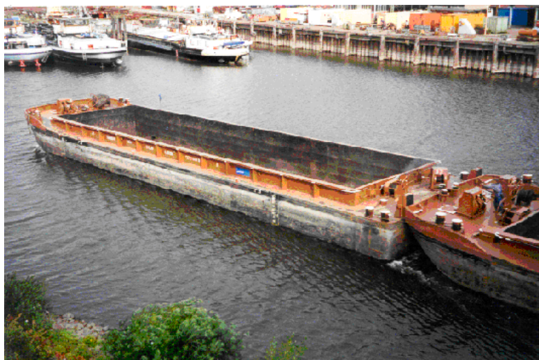
Bild 7: Standard-Schubleichter (hier mit kleinem Leichter und Schubboot der DBR gekuppelt) auf dem Elbe-Seitenkanal Länge 65,00 m / Breite 8,20 m (Laderaum mit "Wallgängen")
